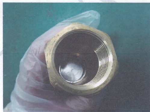
图 27 测试后 4`# 无进水
