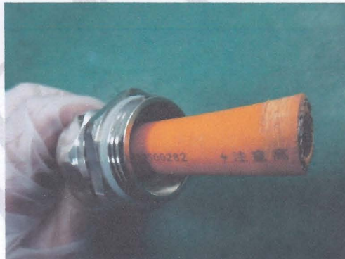
图 26 测试后 4`# 无进水
