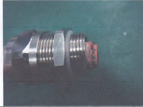
图 30 测试后 6`# 无进水
