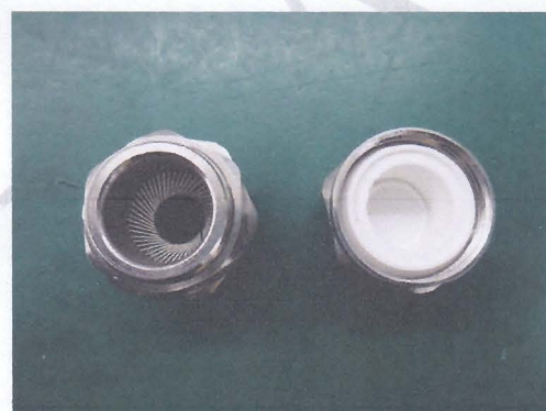
图 16 测试后 6# 无进水
