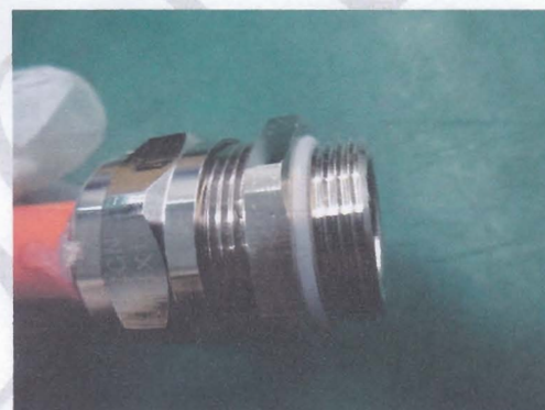
图 20 测试后 1`# 无进水
