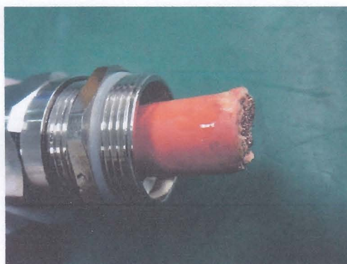
图 24 测试后 3`# 无进水
