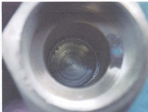
图 31 测试后 6`# 无进水
