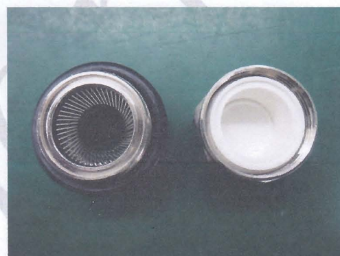
图 15 测试后 5# 无进水
