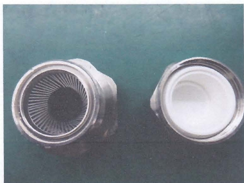
图 12 测试后 2# 无进水
