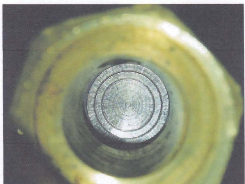
图 23 测试后 2`# 无进水
