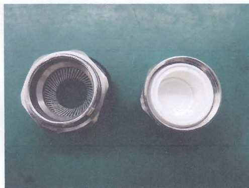
图 13 测试后 3# 无进水
