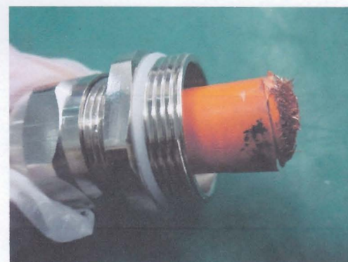
图 22 测试后 2`# 无进水
