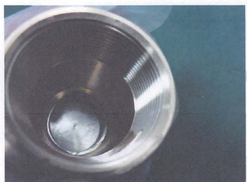
图 25 测试后 3`# 无进水
