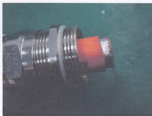
图 28 测试后 5`# 无进水
