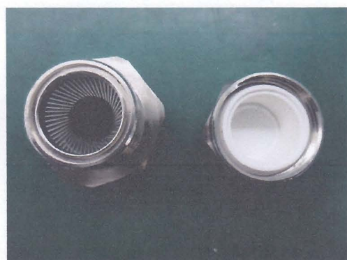
图 14 测试后 4# 无进水
